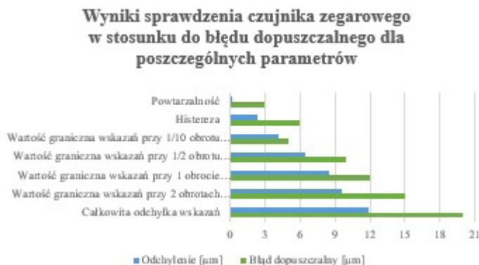
Rysunek 5. Wykres zawierający porównanie wyników pomiarów z dopuszczalnymi błędami dla poszczególnych parametrów
