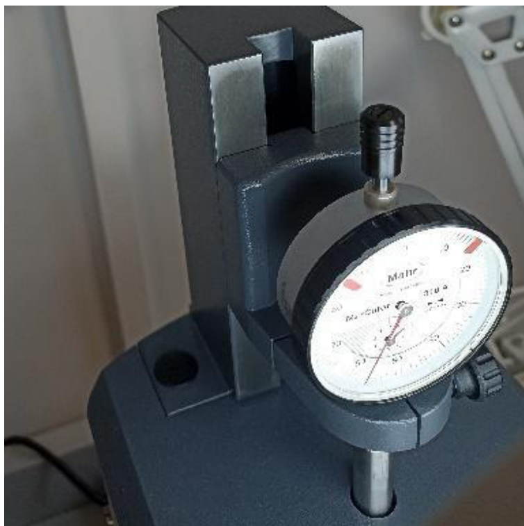
Rysunek 1. Czujnik zegarowy 0-10 [mm] podczas dokonywania potwierdzeń metrologicznych
